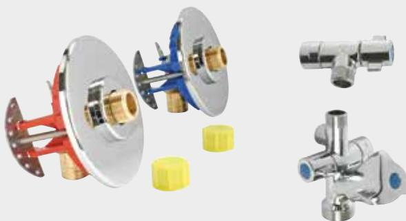
**DESCRIPTION** **Le plus rapide à poser !** - Modules de raccordement doubles avec raccords coudés à glissement mâle 12/17 NF. - Pour installation en tube PER Ø16. - Pour plaque de plâtre standard ou hydrofuge 9,5 à 25 mm. - Diamètre de perçage Ø67 mm. - Conforme aux exigences de la RT2020/2012. - Gabarit de pose sur emballage. - Raccords avec certificat NF 81345. - Livré avec rosaces de finition chromées, un robinet d'arrêt sous lavabo et un robinet multifonctions sous évier.
